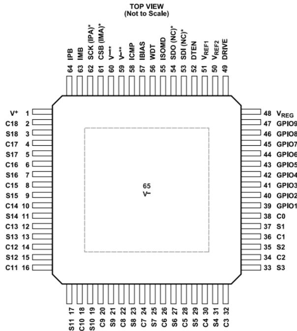
\*THE FUNCTION OF THESE PINS DEPENDS ON THE CONNECTION OF ISOMD:
