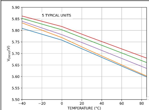
Figure 9. VDRIVE vs. Temperature
