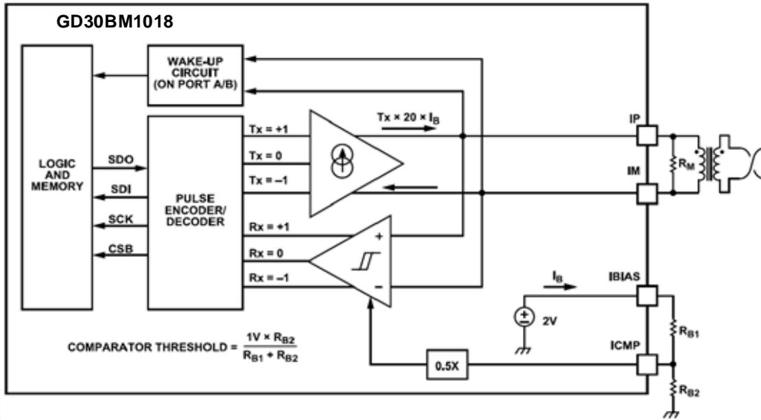
Figure 30. isoSPI Interface
